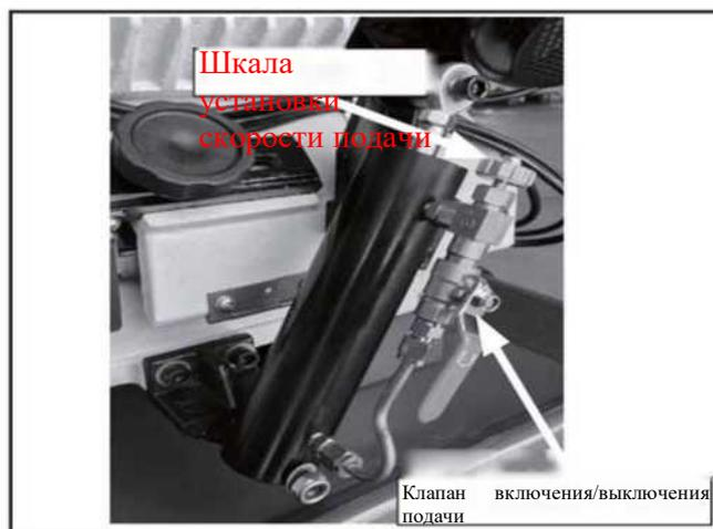
**Рисунок 21.** Расположение клапана включения/выключения подачи.
