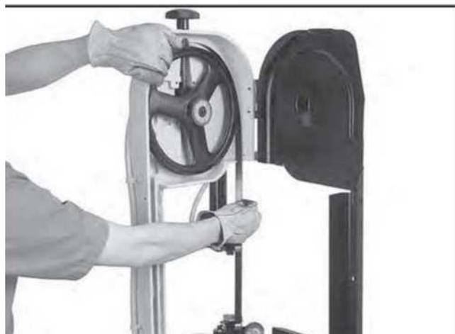
Рисунок 26. Установка ленточного полотна.
